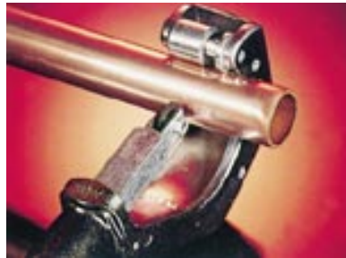
Εικόνα 6.2 Εργαλείο κοπής σωλήνων (σοληνοκόπτης). Στην εικόνα δεξιά, σοληνοκόπτης σε χρήση
