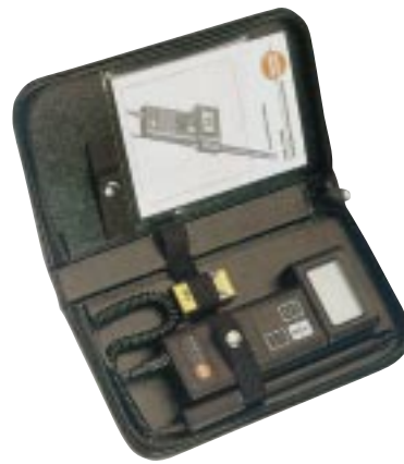
Εικόνα 10.1 Σύγχρονο ψηφιακό πολύμετρο θερμοκρασίας-υγρασίας χώρων
