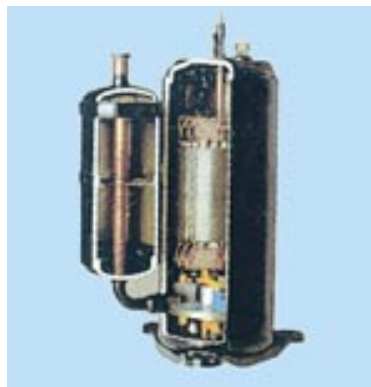
Εικόνα 6.7 Συμπιεστής τύπου τύμπανου (rotary) σε τομή
